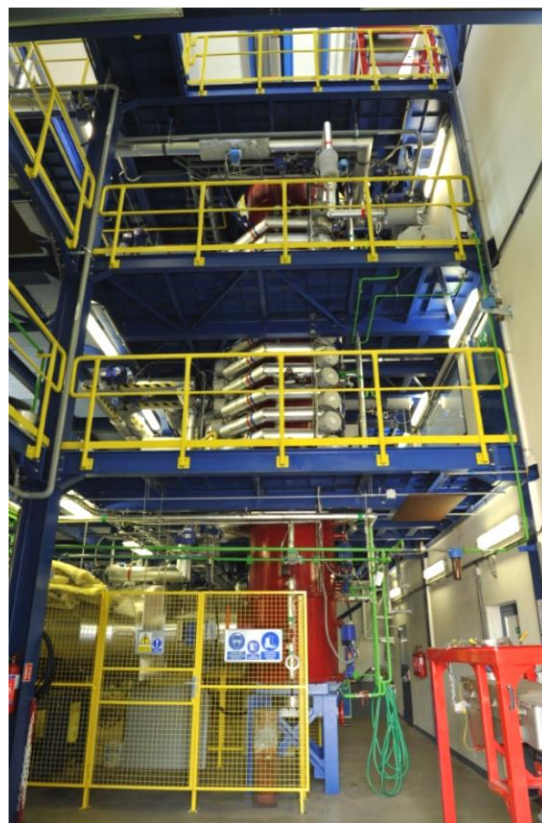
Obr. 4-6: Zkušební spalovací zařízení IVITAS, a.s.: Budova, spalovací komora s pásmovými vzduchy a chlazením, horní část SK s instalovaným hořákem vč. příslušenství.
