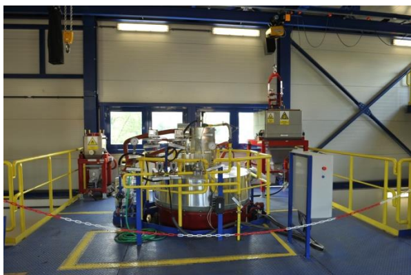
Obr. 4-6: Zkušební spalovací zařízení IVITAS, a.s.: Budova, spalovací komora s pásmovými vzduchy a chlazením, horní část SK s instalovaným hořákem vč. příslušenství.
