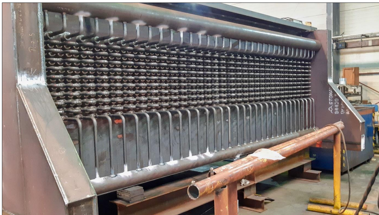
Obr. 10 Výroba parního ohříváku spalin
