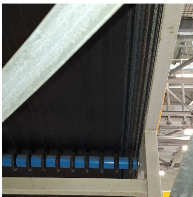
Obr. č. 2 Nevhodná, úzká konstrukce kostry pásového dopravníku a úzká konstrukce gravitační napínací stanice
