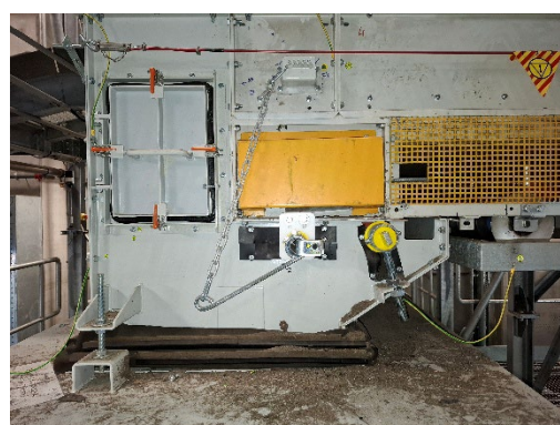
Obr. č. 3 Nedostatečně utěsněné boční vedení a nedostatečný sklon výsypky pod stěračem, převáděcí válec mimo výsypku
